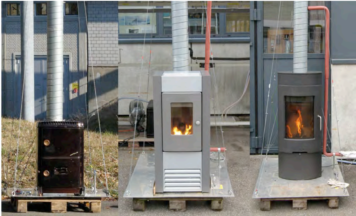
Bild 3 Die verwendeten Öfen. Links ein alter Ofen (Weso, Baujahr ca. 1960); rechts ein moderner Ofen (Attika, Baujahr 2009) und in der Mitte ein Pellet-Ofen (Rüegg, Baujahr 2007).
