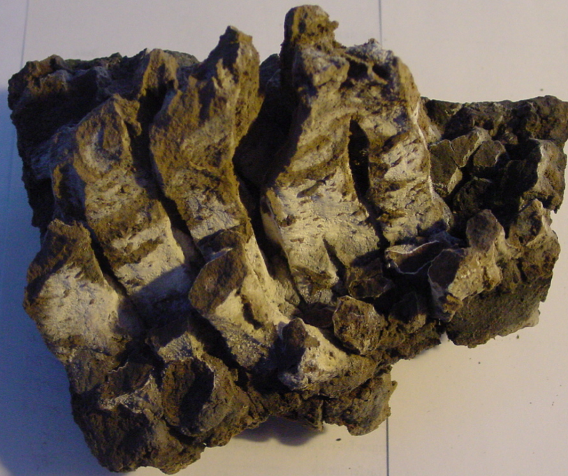
Sinterstück aus einem Havarie-Silo
